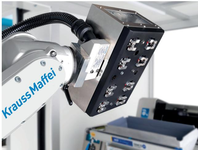
**Bild 2.** Kombinationsgreifer für das Schlitzen der Membran und die Bauteilentnahme © KraussMaffei
