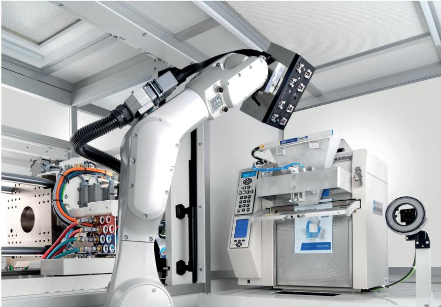
**Bild 1.** Kompakte Automation mit eigener Laminar-Flow-Box, Verpackungsstation und Kamera zur Bauteilkontrolle © KraussMaffei
